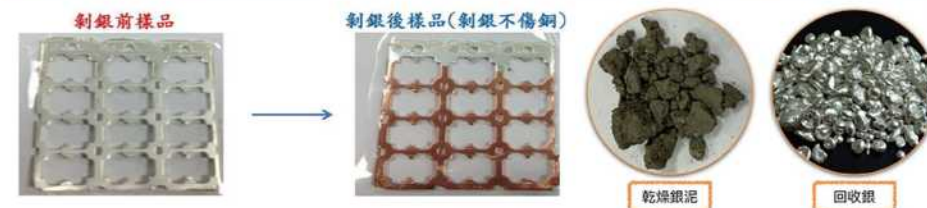
循環經濟貴金屬回收製程實作課程_儀器實體圖_電子廢料中回收銀之成果
